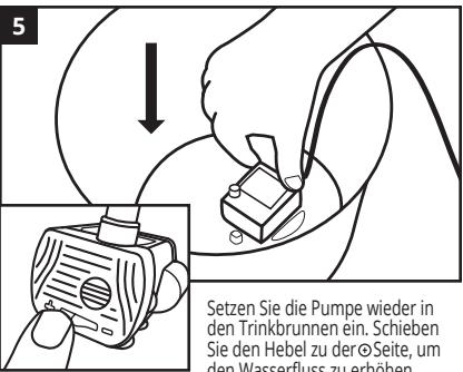
Setzen Sie die Pumpe wieder in den Trinkbrunnen ein. Schieben Sie den Hebel zu der ⓧ Seite, um den Wasserfluss zu erhöhen.
