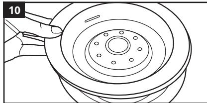
Setzen Sie den Edelstahleinsatz wieder auf. • Replace stainless steel top. • Remettre le dessus en acier inoxydable en place. • Vuelva a colocar la tapa de acero inoxidable en su sitio. • Volte a colocar a tampa de aço inoxidável no sítio. • Plaats het fonteindeksel. • Wymiana pokrywy ze stali nierdzewnej. • Cserélje a rozsdamentes acél tetőt. • Sostituire la parte superiore in acciaio inossidabile. • Sæt overdelen af rustfrit stål på. • Установите верхнюю часть из нержавеющей стали
